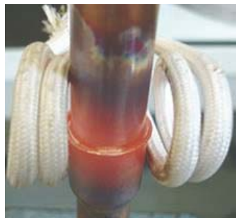
Sl. 1.4-1. Neke primene indukcionog grejanja u metalurgiji
