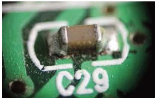
Slika 1.2 Površinska komponenta spojena na štampanu ploču.
