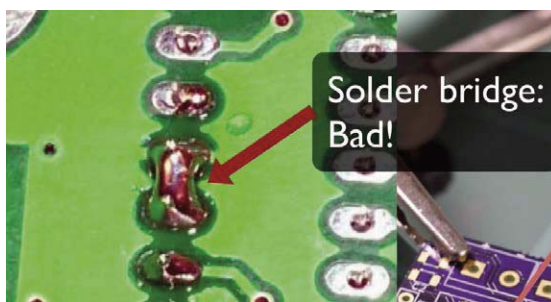
Slika 1.5 Mostić od lema je jedan od defekata koji sprečava lemna maska.
