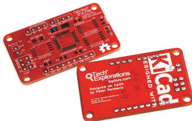
Slika 1.3 Bela slova i linije su naneseni sito štampom na ovu štampanu ploču.
