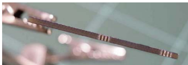
Slika 1.6 Ova štampana ploča ima debljinu od 1.6 mm i napravljena je od fiberglasa
