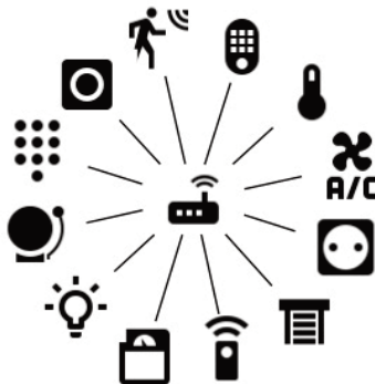
Slika 1.1 Sistem kućne automatike se sastoji od centralnog gejtveja i raznih kontrolabilnih uređaja i senzora
