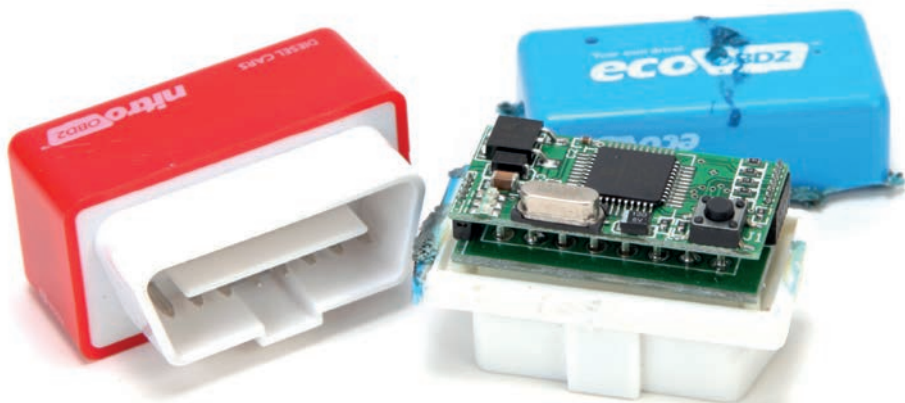
Slika 4.1 Adapter nitroOBD i ecoOBD ne donose poboljšanja.
