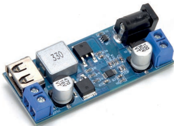
Slika 9.2 Step Down pretvarač napona sa stabilnim naponom (5 V) na USB priključku i klema sa vijcima
