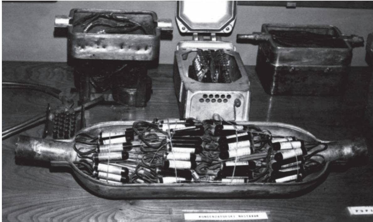
Пупинови калемови (деталји са сталне изложбе у Идвору) Pupin coils (details from the permanent exhibition in Idvor)
