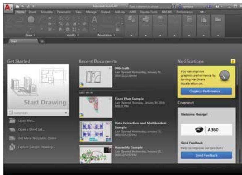
Na slici 1.2 prikazan je tipičan izgled prozora programa AutoCAD. Možete ga organizovati po sopstvenoj želji i sačuvati kao *radni prostor* (engl. *workspace*). Radne prostore možete snimati i pozivati u svakom trenutku pomoću alatke Workspace Switching s palete Quick Access. (Više o ovoj alatki saznaćete u narednom poglavlju.) Podrazumevani radni prostor sa slike 1.2 zove se Drafting & Annotation, i jedan je od nekoliko radnih prostora ugrađenih u AutoCAD.
