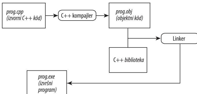
Ako izgradnja uspe, možete sebe da potapšete po ledima: ni kompjajler ni linker nisu naišli na greške. Da li to znači da ste gotovi? Ne. Kompajler hvata sintaksne greške, kao i greške programske strukture. Ali ima mnogo grešaka koje on ne može da pronađe. Pogledajmo jednu analogiju... uzmimo da imate sledeću rečenicu:
