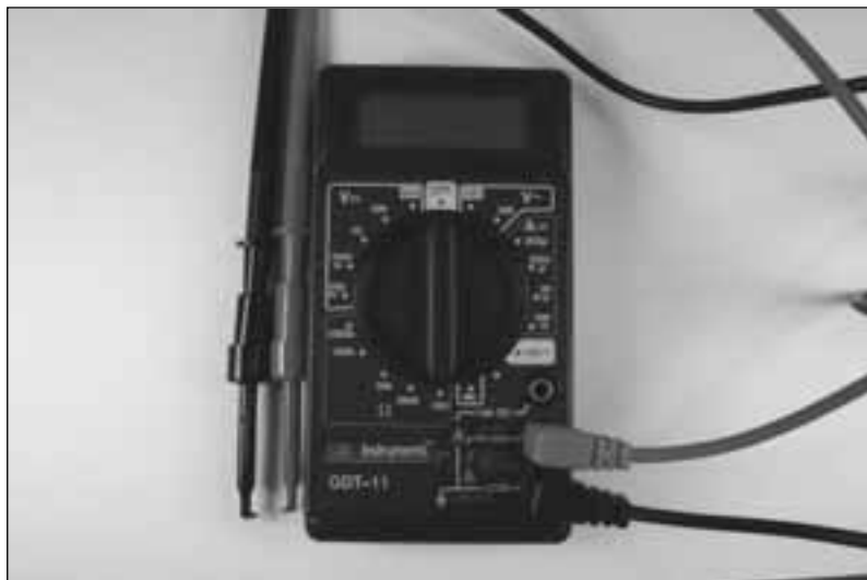
Slika 1-3: Multimetar je merni instru- ment koji ćete često koristiti.
